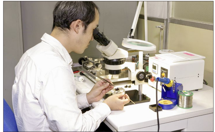
Tonabnehmerfertigung ist Präzisionsache. Vieles geschieht unter dem Mikroskop. Bei Excel stehen spezialisierte Arbeitsplätze bereit.
